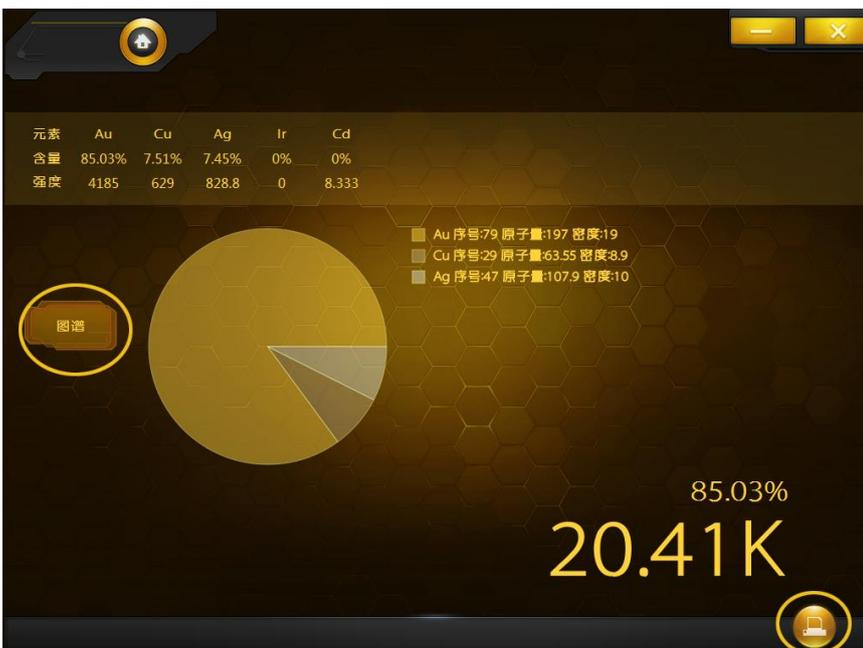
至此，整个测试过程完成。为了得出更准确的结果，用户可以多测试 3—5 次，然后计算平均结果。
