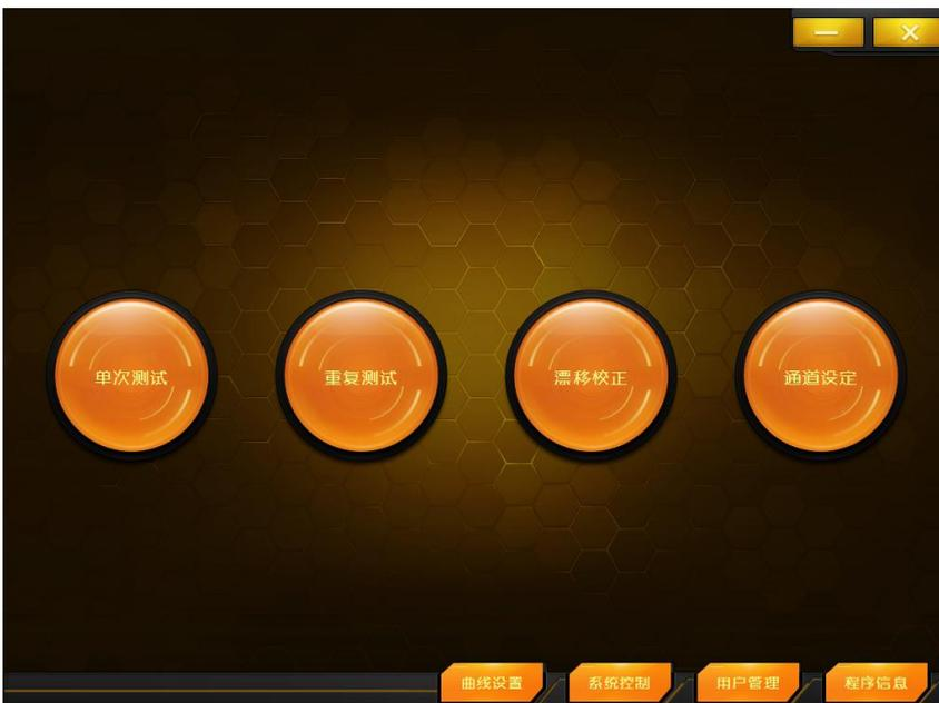
(2) 点击测试按钮后，会出现以下对话框，点击“确认”后进行漂移校正，校正成功后会显示“完成峰位微调”。如不显示则表示校正不成功，请移动银样品位置后再次进行漂移校正。
