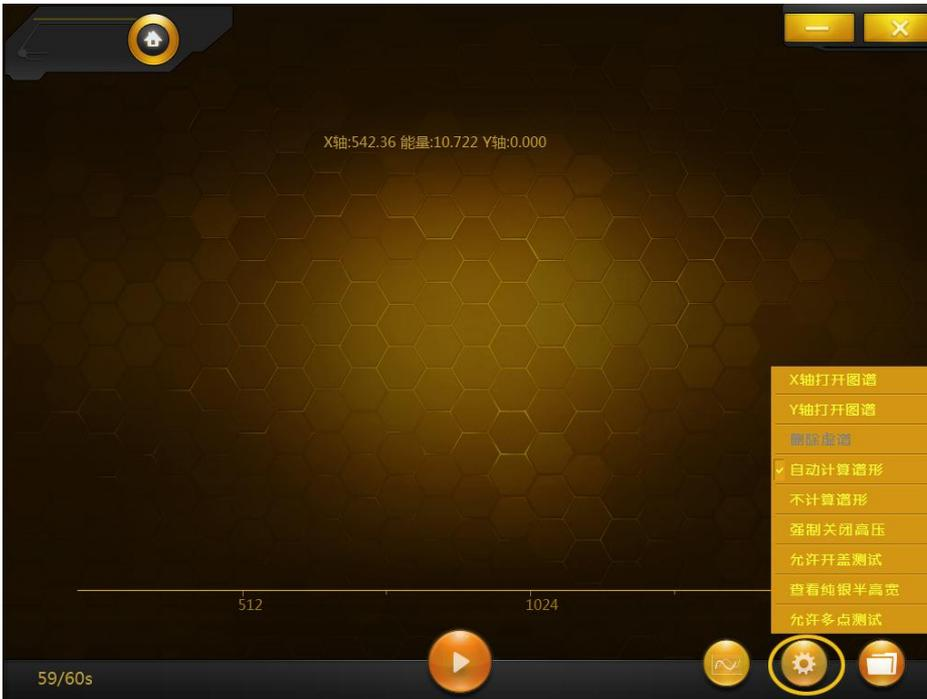
●允许开盖测试：若样品很大，导致盖子无法关闭，可切换至“允许”开盖模式进行测试，仅限特殊情况使用。
